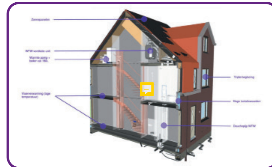
Doorsnede woning en energie besparende maatregelen
